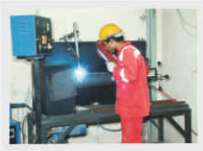
CO 2 Mig Welding
